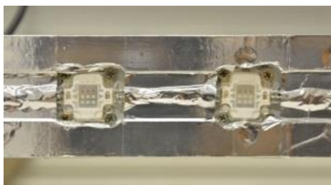
Figura 19 - LEDs fixados no suporte do módulo com as bases 1 e 2 que apoiam o módulo no suporte.
