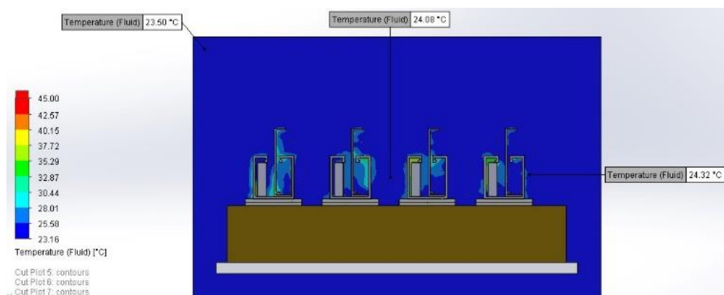
Figura 67 - Vista lateral esquerda - Temperatura do fluido com o plano de corte próximo aos ventiladores.
