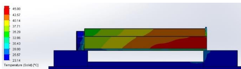
Figura 35 - Análise térmica da vista posterior do emissor de luz com o gradiente de temperatura do módulo 1.
