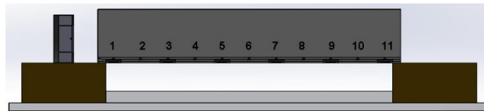
Figura 95 - Marcação dos pontos de medição no módulo 1, corte no meio do módulo representados pelo plano “A” – Vista frontal.
